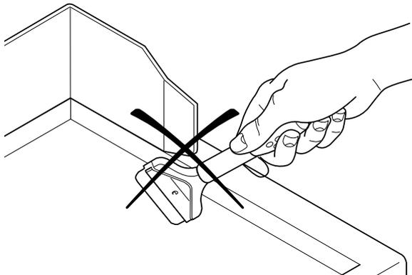
**Atención: no usar el rascador con punta** (ver figura) ya que puede rayar la plancha, perjudicar su funcionamiento y dificultar la limpieza. Sustituir la hoja si no está perfectamente afilada.
