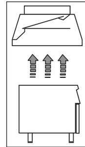
**¡Nota!** El sistema tiene que garantizar que: a) la salida de humos no pueda obstruirse; b) la longitud del tubo de salida no sea superior a 3 m. Utilizar un adaptador para empalmar los conductos de salida con diámetros diferentes.
