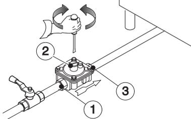
**¡NOTA!** Estos modelos han sido diseñados y certificados para funcionar con metano o propano. Si se utiliza metano, el regulador de presión del colector ha de estar en 8" w.c. (20 mbar).
