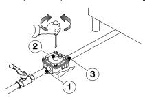
**NOTA** Estos modelos han sido diseñados y certificados para funcionar con metano o propano. Si se utiliza metano, el regulador de presión del colector ha de estar en 8" w.c. (20mbar).
