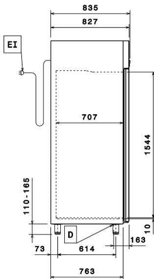
EI = Conexión eléctrica (energía)
