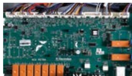
f. La **classe IP25** protège des dommages occasionnés par les petits animaux, comme les souris. Elle protège également des jets d'eau provenant de n'importe quelle direction. Les connecteurs résistants à l'eau et à l'humidité, les panneaux électroniques double face avec double couche de protection contre les surtensions complètent la protection de l'appareil.
