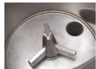
Scarico dell'acqua residua
