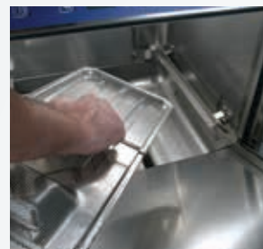
Gemakkelijk te verwijderen filter
