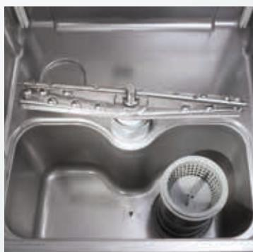
**Fonctionnement de longue durée.** Tous les composants en contact avec de l'eau et des produits chimiques sont fabriqués en acier inox AISI 304
