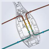
Sistema di ventilazione che consente di lavorare più a lungo senza surriscaldare il motore
