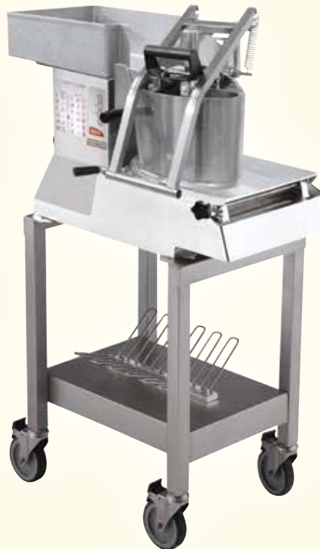
Stangengemüsetrichter mit 3 Röhren (Ø 50 bis 70 mm)
