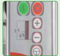
Flaches, wasserfestes Bedienfeld (IP55)
