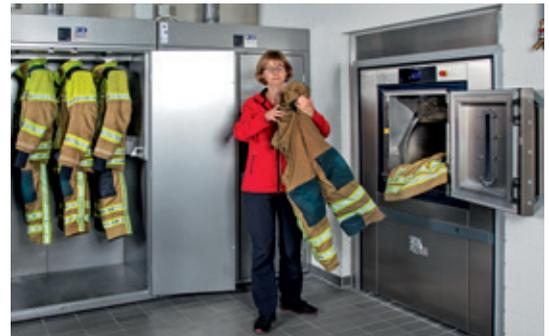
Zur Prozesssicherheit gehören **klar definierte Waschprogramme**, in welchen die Waschmittel vollautomatisch dosiert werden. Da die Line 6000 Waschmaschinen über ein **integriertes Wiegesystem** verfügen, wird das Waschmittel exakt auf das reale Beladegewicht dosiert.
