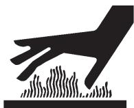
Denne tegningen opplyser brukeren om høy temperatur som kan forårsake alvorlig brannskade. Enkelte flater kan nå en temperatur på 200 °C (392 °F).
