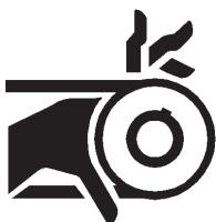
Dette bildet opplyser brukeren om farlig mekanisme inne i maskinen. Beskyttelses skjermene skal være på plass når maskinen er i gang.
