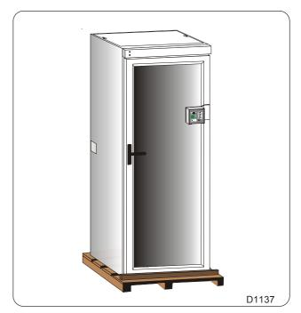
Hacer bajar la máquina de la paleta con precaución empujándola suficientemente hacia <u>atrás</u> para poder moverla y retirar la paleta.
