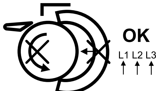
(B) Richtige Phasenfolge und Wanne geöffnet.
