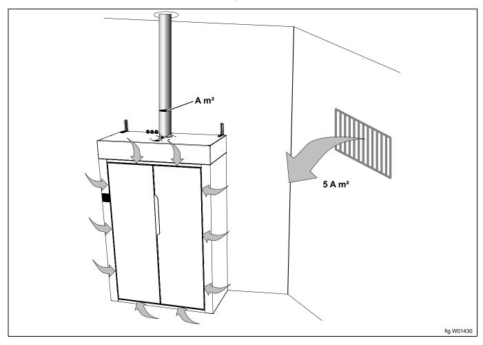
Die Luft wird von zwei Lüftern durch einen Lufteinlass im Oberteil des Schranks und durch die Türschlitze in den Schrank eingesaugt.
