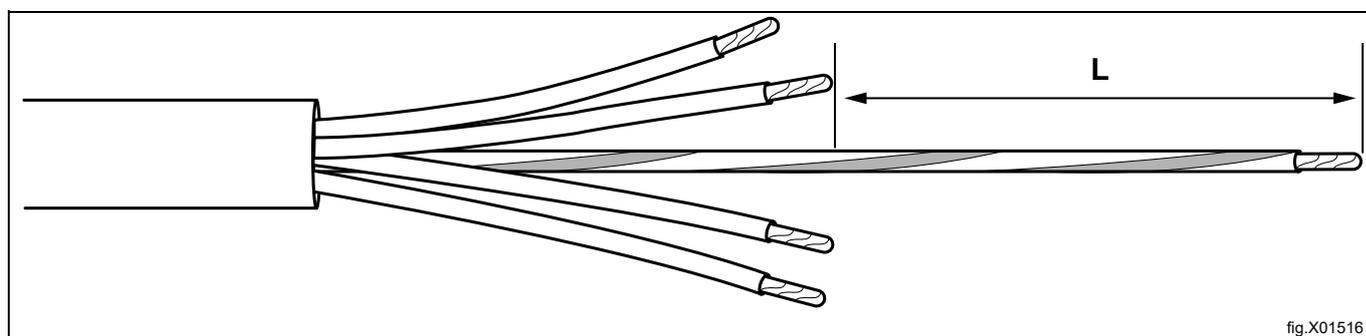
Quando o cabo de alimentação tiver sido preparado de acordo com a tabela, enrole o fio de terra de proteção (PE) ao longo do ferrite e, de seguida, ligue todos os fios de acordo com as seguintes opções de ligação.
