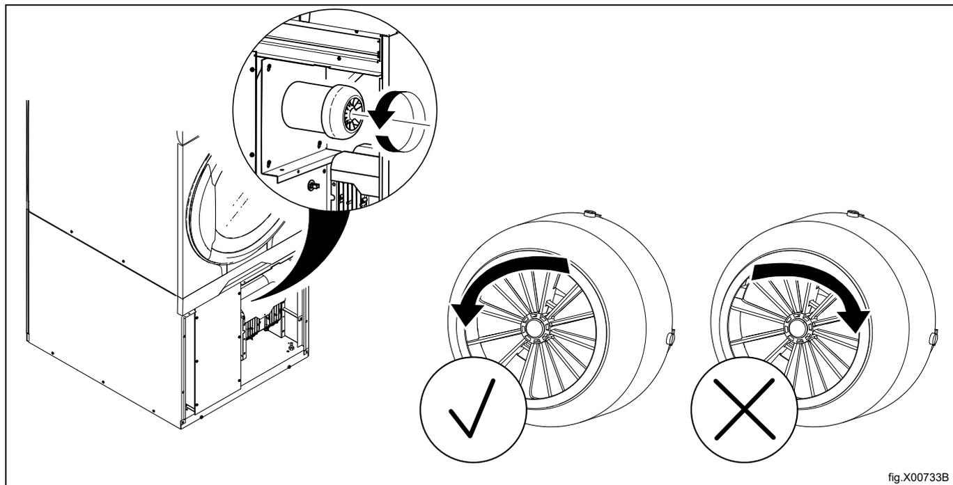
Se a direção do motor da ventoinha estiver errada, troque duas das três fases para a esquerda no terminal de ligação.
