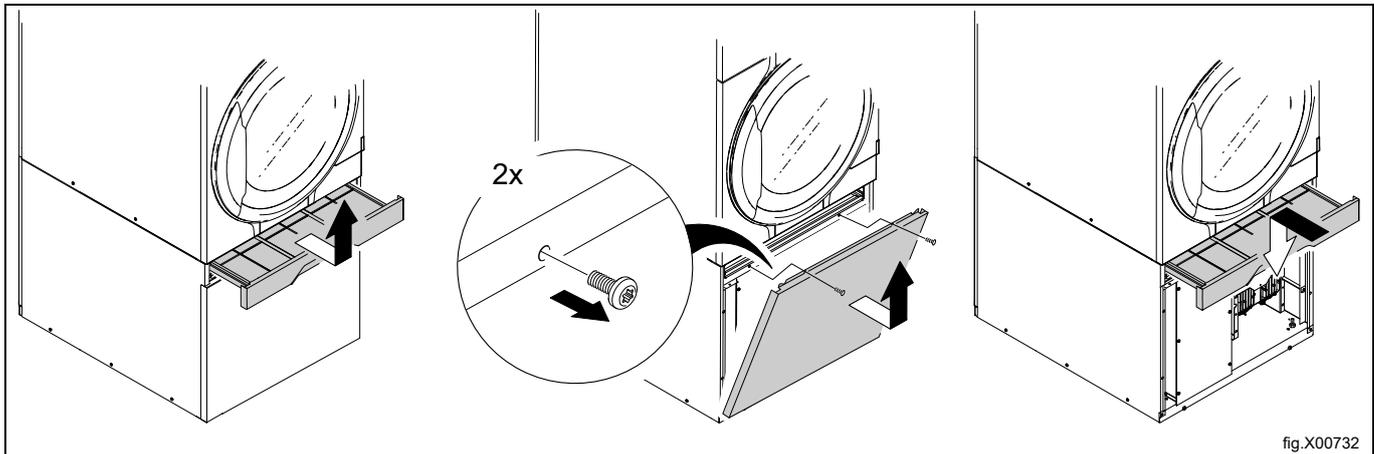
An einer Maschine mit Trommeldrehzahlregelung müssen Sie außerdem die Abdeckung des Ventilatormotors abnehmen.
