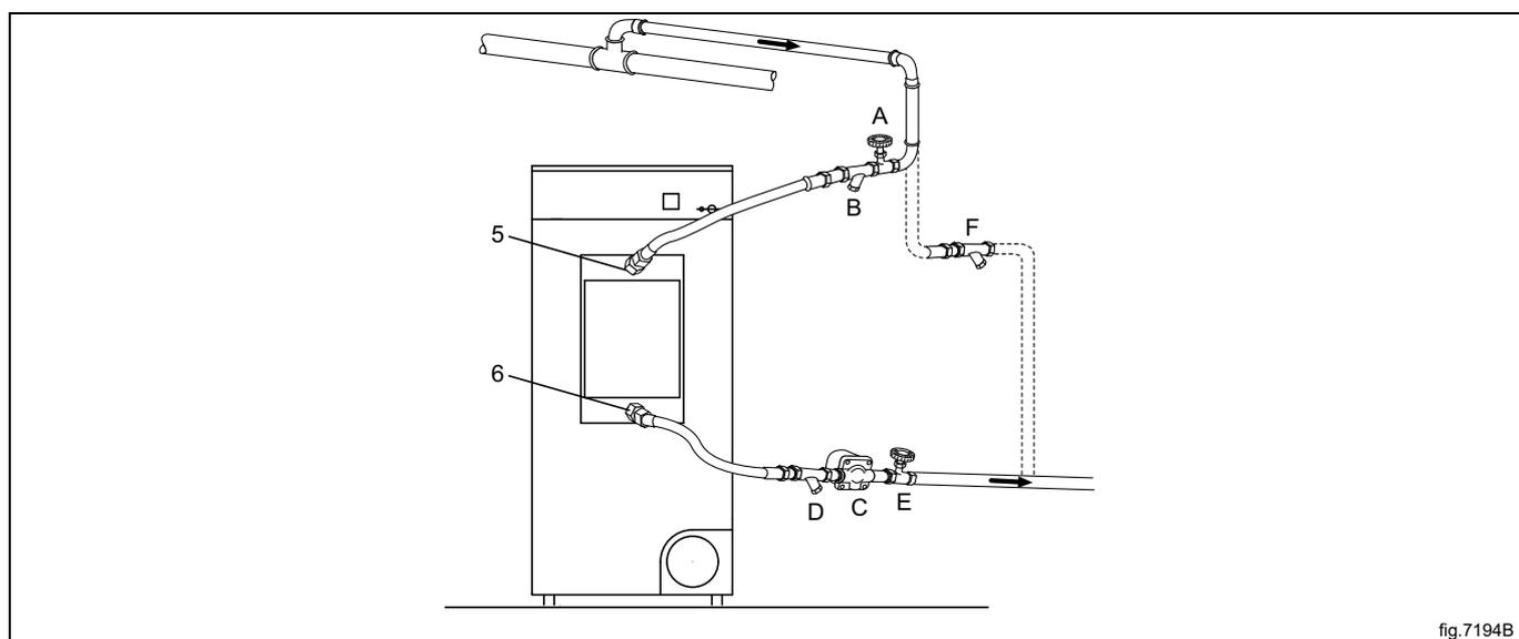
Befestigen Sie die Druckschläuche an den Abzweigrohren, die die Verbindung zu Ein- und Auslass herstellen. Die Abzweigrohre, die die Verbindung zu Ein- und Auslass herstellen, müssen abgestützt werden, damit sie sich nicht verformen.
