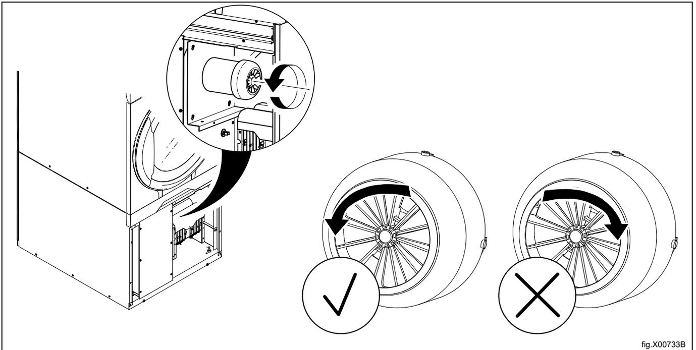
Falls die Drehrichtung des Gebläsemotors nicht korrekt ist, vertauschen Sie zwei der drei Phasenanschlüsse links auf dem Anschlussklemmenblock.
