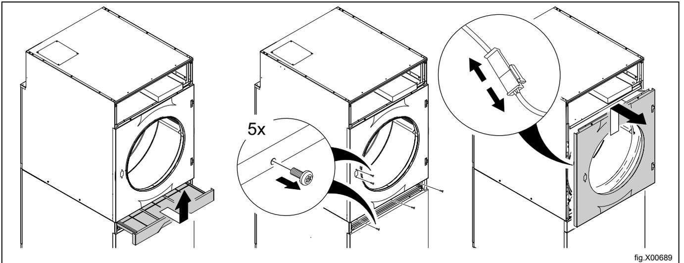
Retire o parafuso superior, a tampa e o parafuso inferior no lado direito.
