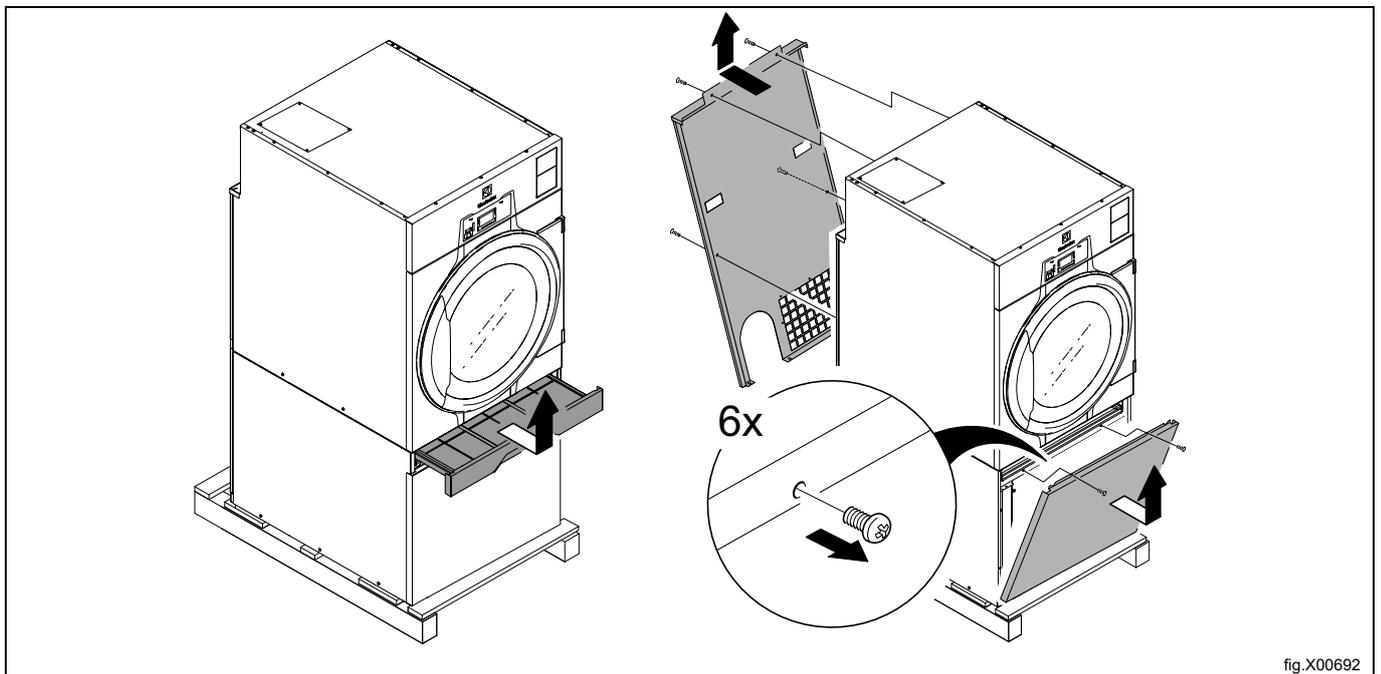
Retire os parafusos existentes entre a máquina e a paleta.
