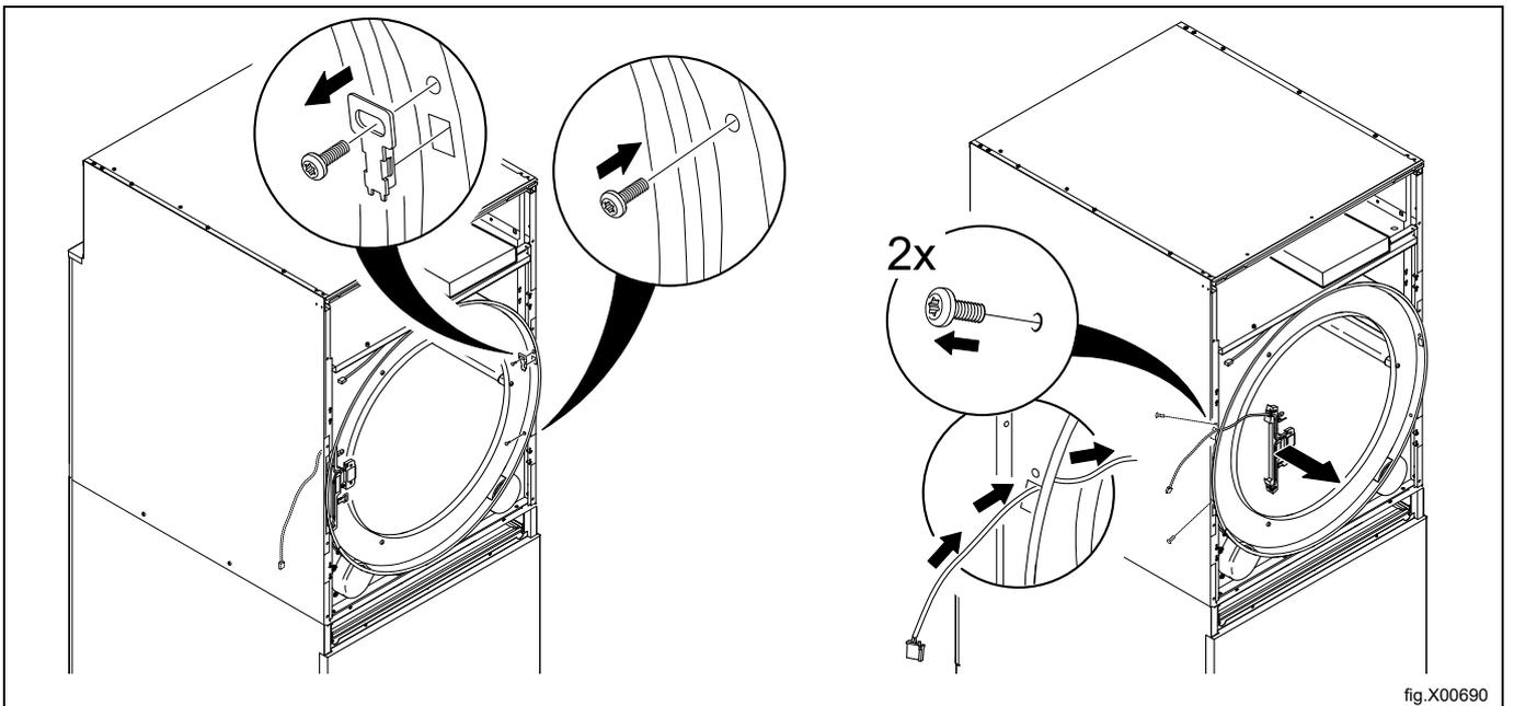
No suporte do interruptor de lâminas, puxe para fora e desloque o cabo do interruptor da porta da posição superior para a posição inferior de acordo com a figura. Certifique-se de que o cabo e a peça terminal estão na posição.
