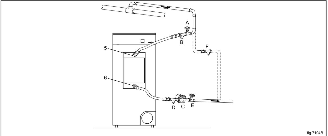
Conecte las mangueras de presión a las conexiones de entrada y salida de las máquinas. Es importante que las conexiones de entrada y de salida sean sólidas a fin de evitar deformaciones.
