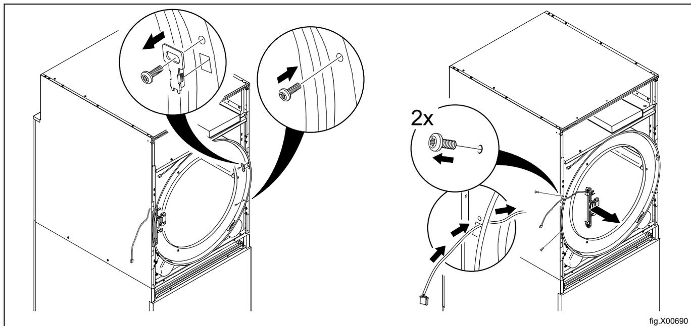
En el soporte del interruptor magnético, tire del cable y desplácelo de la posición superior a la inferior, de acuerdo con la figura. Cerciórese de que el cable y la pieza final estén en su posición.
