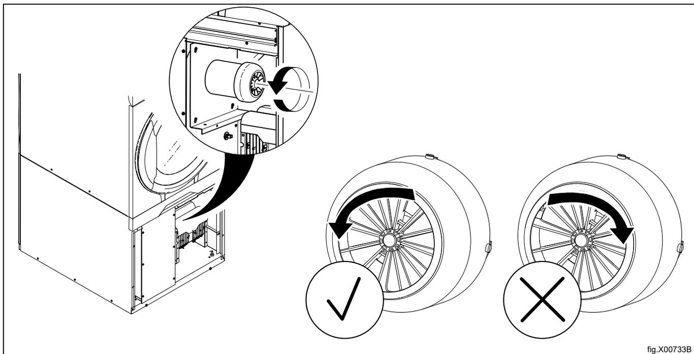
Si le sens du moteur du ventilateur n'est pas correct, déplacez deux des trois phases vers la gauche au niveau de la borne de connexion.
