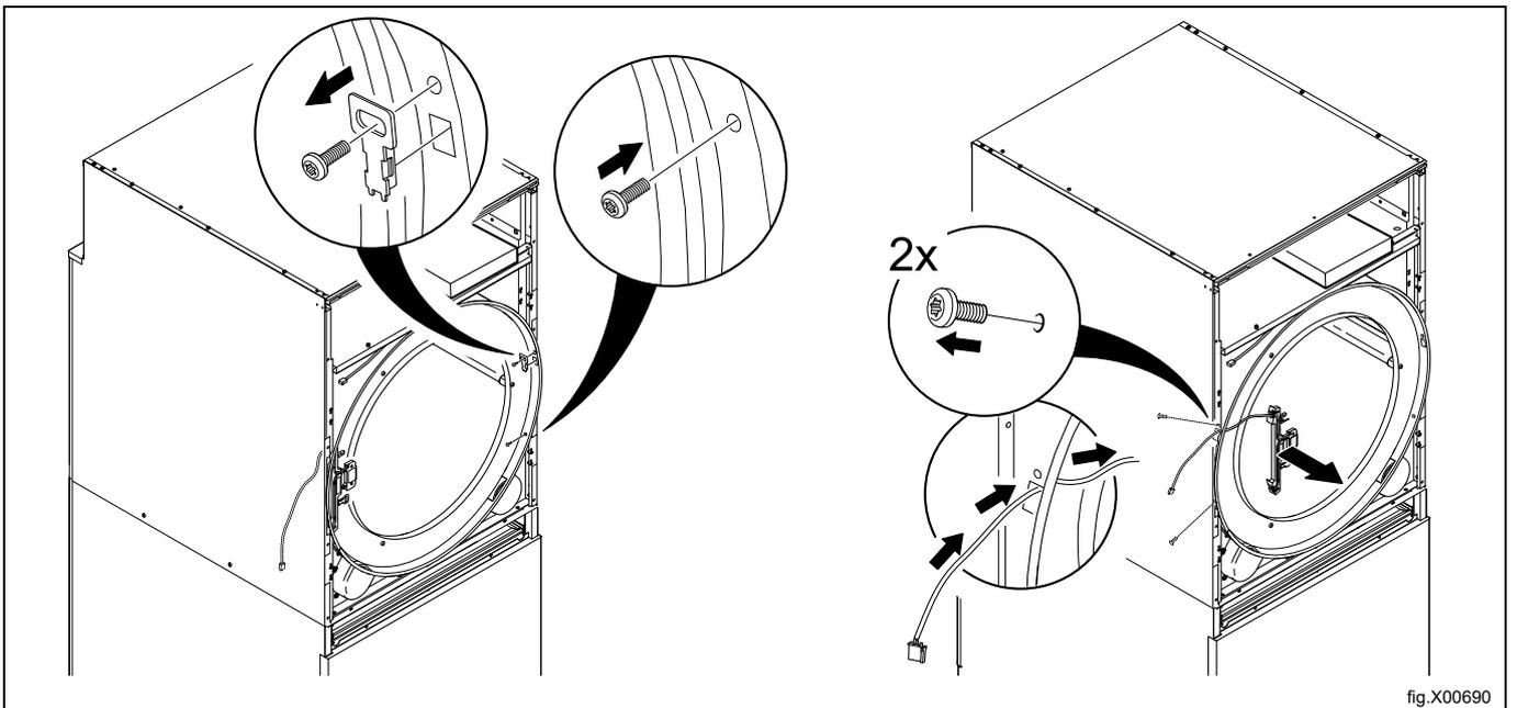
Sur la bride du capteur magnétique, extrayez le câble du contacteur de porte et déplacez-le de haut en bas, comme illustré. Vérifiez que le câble et la pièce d'extrémité sont bien en place.
