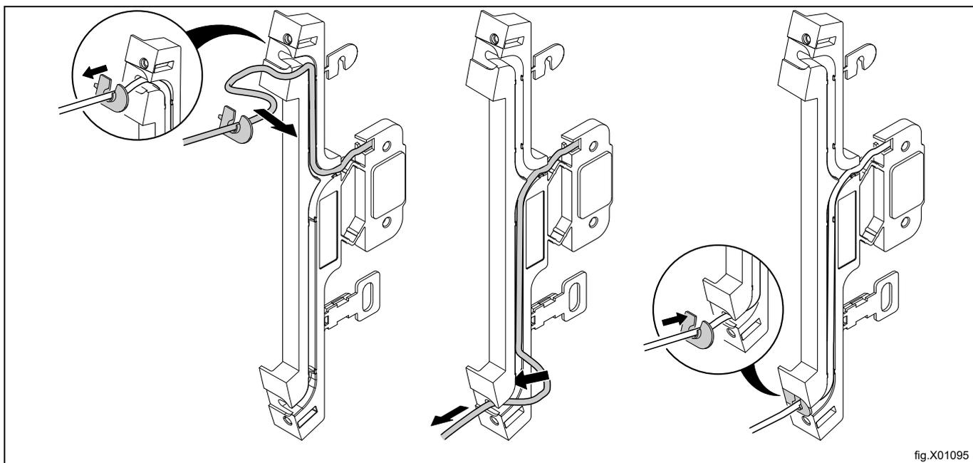
Mettez la bride du capteur magnétique à l'envers et montez-la sur le côté droit. Faites passer le câble du contacteur de porte à travers le trou et branchez-le.
