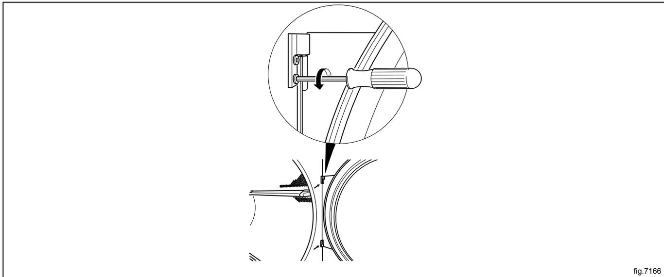
Quite los tornillos del panel frontal y retire el panel con cuidado. Presione el cable del interruptor de la puerta a través del orificio para poder introducir el cable y después desconéctelo. Retire el panel.
