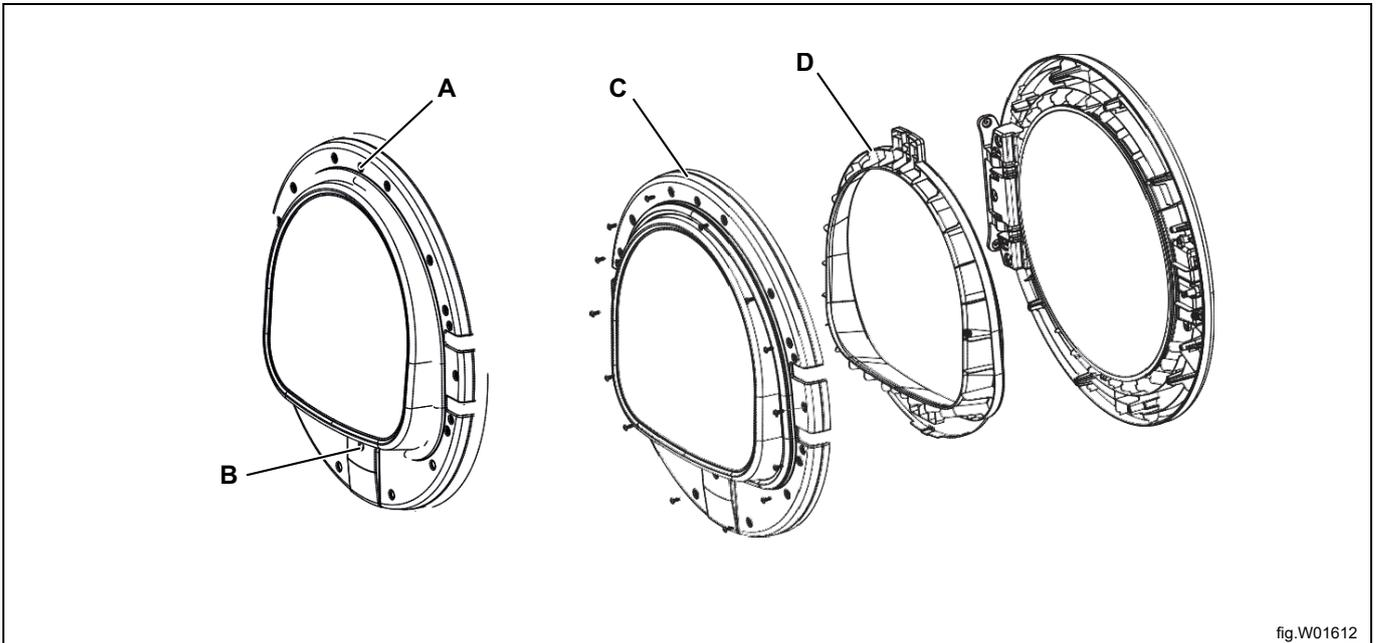
Desmonte los dos imanes (A) y la cubierta protectora (B), y desplácelos al lado opuesto.
