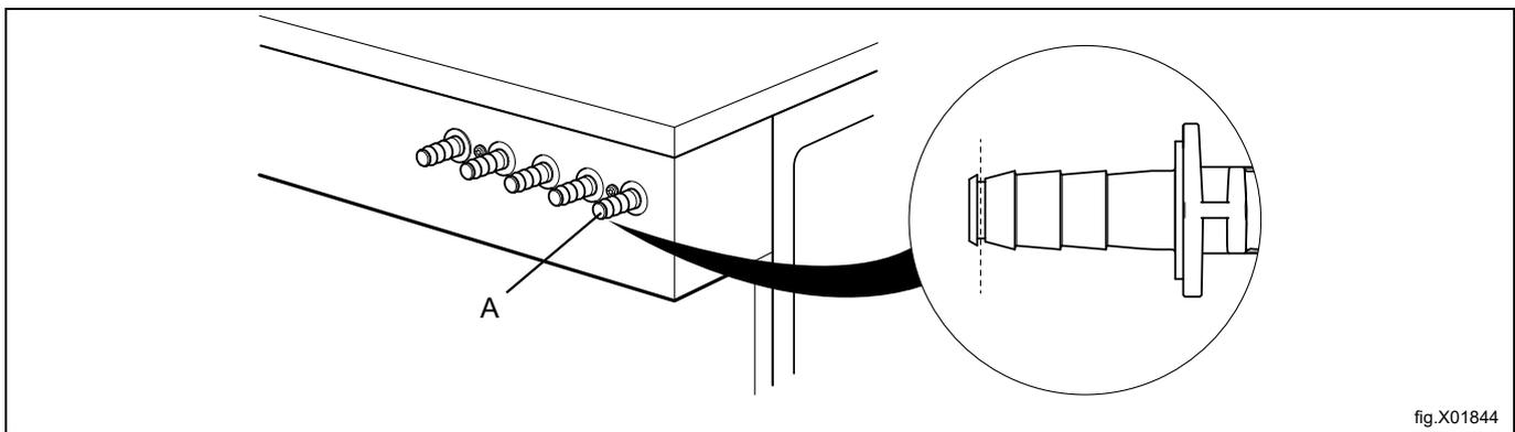
Conecte siempre las mangueras en las conexiones con una abrazadera de manguera.
