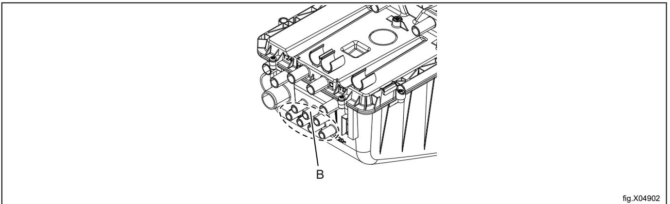
Conecte siempre las mangueras en las conexiones con una abrazadera de manguera.
