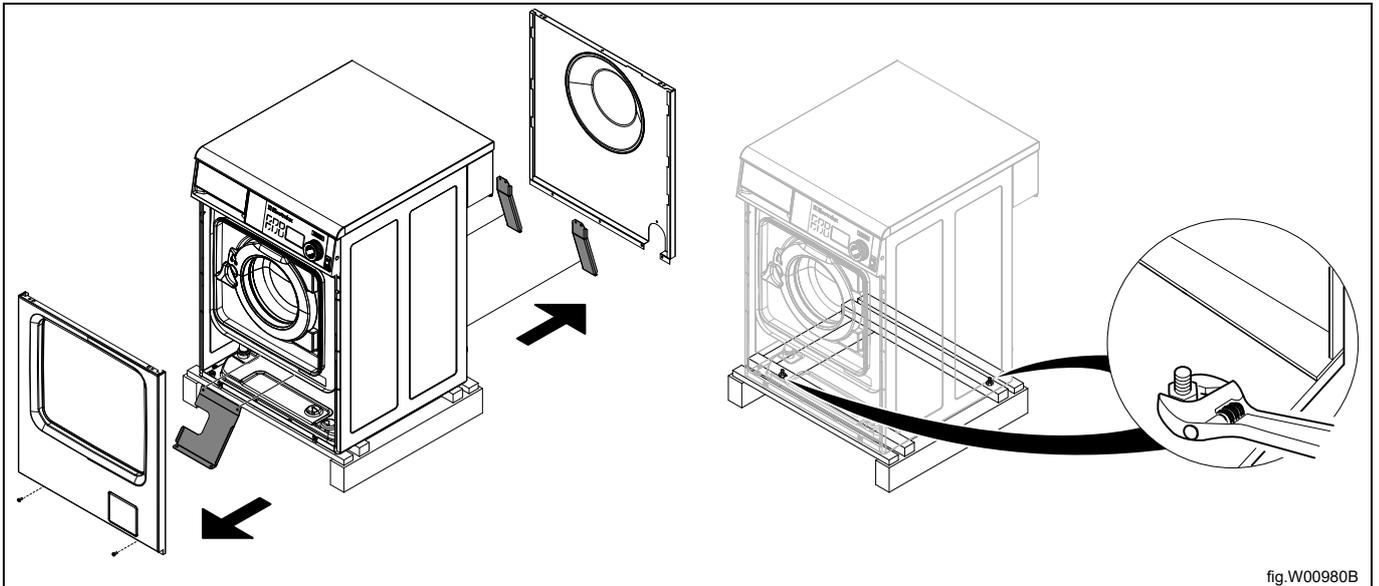
Nehmen Sie die Maschine von der Palette herunter. Die Maschine muss am unteren Rahmen angehoben werden.
