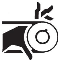
Dieses Symbol zeigt dem Anwender das Vorhandensein von gefährlichen Mechanismen im Maschineninneren an. Die Schutzgehäuse müssen für den Betrieb aufgebaut werden.
