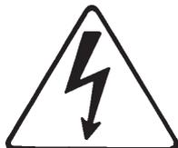
Das gleichseitige Dreieck, in dem sich ein Blitz mit einem Pfeil am Ende befindet, zeigt dem Anwender das Vorhandensein einer nicht isolierten, «gefährlichen Spannung» im Inneren der Anlage an; der Spannungswert kann ausreichen, um einen elektrischen Schlag auszulösen.
