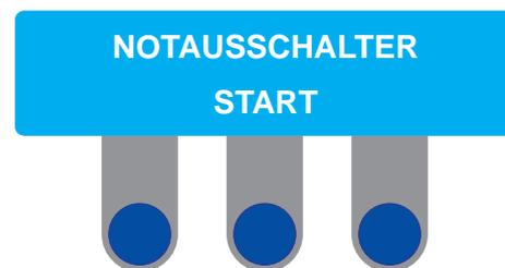
Sie können nun die zentrale Taste des Bedienungsfelds betätigen, um in den Funktionmodus der Maschine zurück zu kehren.
