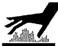
Questo simbolo previene l'utente sulla presenza di temperature elevate che possono provocare ustioni gravi. Alcune superfici si possono avvicinare ai 200° C (392 °F).
