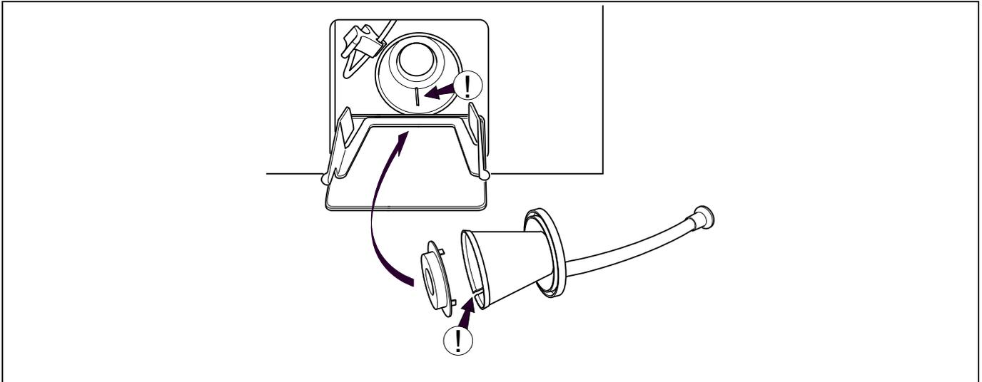
Prüfen Sie regelmäßig Ablaufanschluss, Verbindungsstellen im Abflussrohr usw. und entfernen Sie Flusen und Schmutz. Nutzen Sie zur Reinigung beispielsweise eine kleine Bürste. Achten Sie beim Wiedereinbau darauf, dass die Anschlüsse dicht sind.
