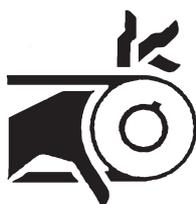
Ce symbole prévient l'utilisateur de la présence de mécanismes dangereux à l'intérieur de la machine. Les carters de protection doivent être en place lors de l'utilisation.
