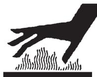
Ce symbole prévient l'utilisateur de la présence de hautes températures pouvant provoquer des brûlures graves. Certaines surfaces peuvent approcher les 200 °C. (392 °F.).
