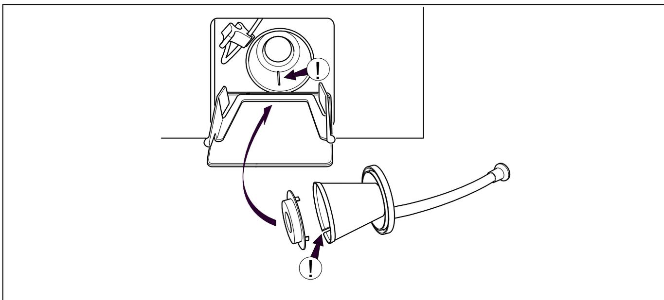
Vérifiez régulièrement le raccord de vidange et les joints du tuyau de vidange et retirez les dépôts. Nettoyez-les à l'aide d'une petite brosse, par exemple. Lors du remontage, vérifiez l'étanchéité des raccords.
