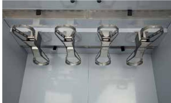
Risultati di asciugatura migliori con quattro robusti appendiabiti di aeraggio per facilitare il flusso di aria tra gli abiti. Mediante gli speciali appendiabiti per indumenti, in primo luogo l'aria calda viene soffiata all'interno degli abiti e poi all'esterno. La parte superiore dell'armadietto di asciugatura contiene anche quattro filtri per la lanugine.
