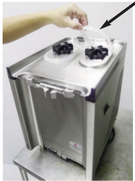
Monter le joint sur le bac.
