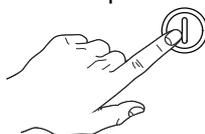
Il tasto "A" si accende (Tabella 2 "Pannello comandi") ed indica che la lavastoviglie è sotto tensione e sta effettuando il caricamento ed il riscaldamento dell'acqua. Durante l'intera fase di caricamento e riscaldamento sul display si legge "FILL":
