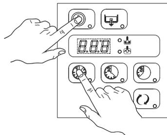
Pulse el botón ("N" – Tabla 2 "Panel de control") dos veces para acceder a los parámetros de ajuste del detergente y el abrillantador.
