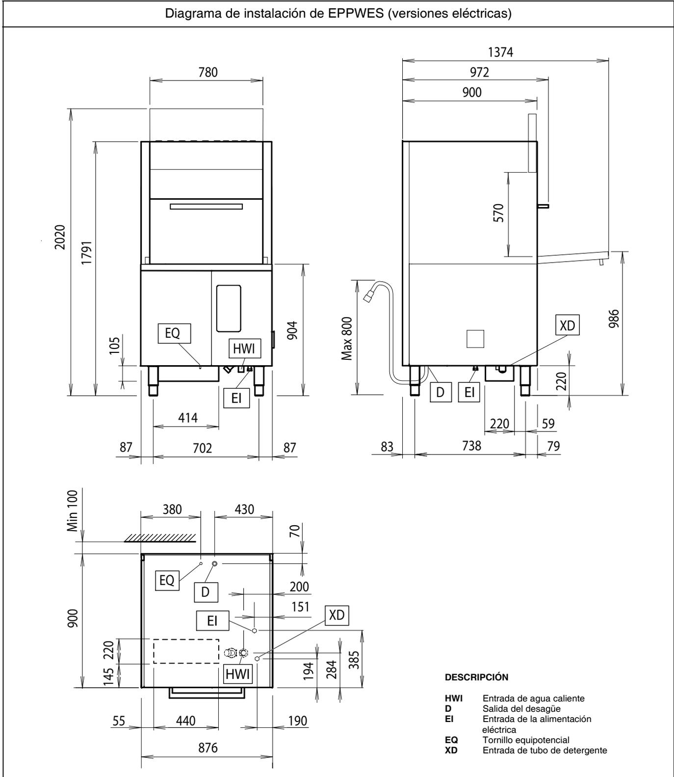
Diagrama de instalación de EPPWEH (versiones eléctricas)
