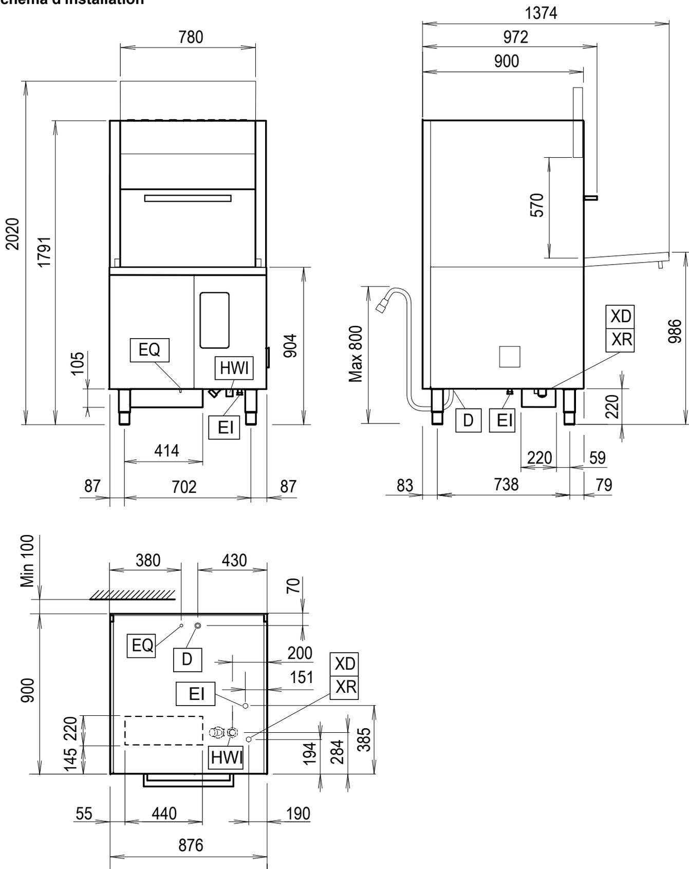
HWI = Tuyau d'arrivée d'eau chaude  $\varnothing=3/4"$  G
