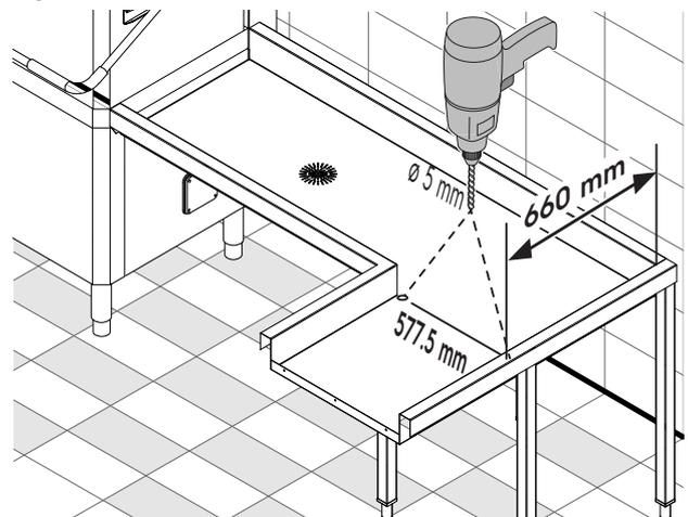
4. Coloque el equipo sobre la mesa haciendo coincidir los orificios que acaba de realizar con las patas delanteras (consulte la figura siguiente).
