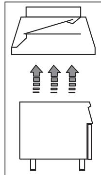
**Nota!** Il sistema deve garantire che: a) lo scarico fumi non sia ostruito; b) la lunghezza del tubo di scarico non sia superiore a 3 m. Utilizzare l'adattatore per raccordare condutture di scarico aventi differenti diametri.
