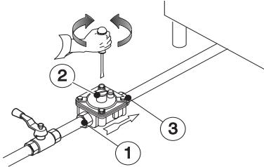
**NOTA!** Questi modelli sono progettati e certificati per l'uso con gas metano o propano. Per il metano il regolatore di pressione sul collettore è settato a 8" w.c. (20mbar).
