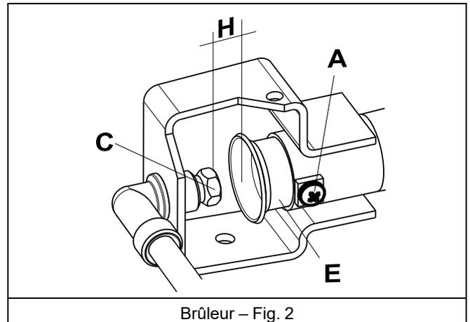
L'air primaire est correctement réglé lorsque la flamme ne se détache pas avec le brûleur froid et lorsqu'il n'y a pas de retour de flamme avec le brûleur chaud.
