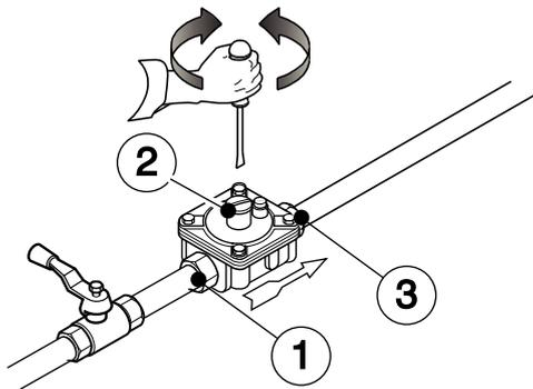
**MARCHÉ AUSTRALIEN** : le régulateur de pression de gaz fourni avec l'appareil doit être monté à l'entrée de l'appareil.
