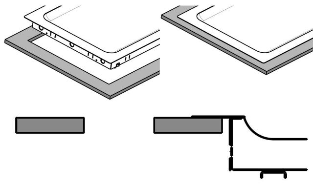
2) Apparatuur op gelijke hoogte met de bovenkant
