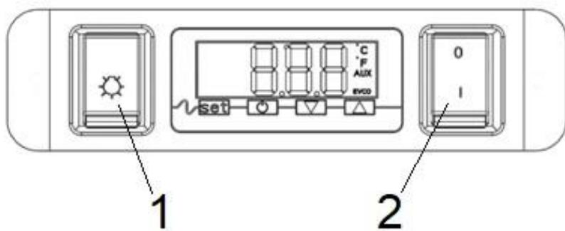
1. Interrupteur ON/OFF de l'éclairage LED au-dessus du présentoir
