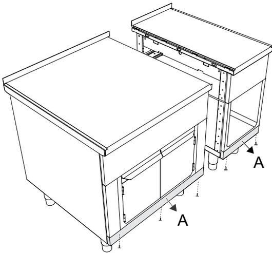
2. Schieben Sie die Geräte aneinander. Bringen Sie die Geräte mit den verstellbaren Füßen auf die gleiche Höhe und richten Sie sie dann waagrecht aus. Schrauben Sie die Geräte unten mit Schraube, Unterlegscheibe und Mutter **B** aneinander. Bringen Sie Blende **A** mit den Schrauben wieder an.
