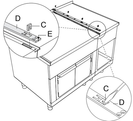
4. Dichten Sie die Verbindung auf ihrer gesamten Länge mit dauerhafter Silikon-Dichtmasse ab (wir empfehlen graue Fugendichtung, Teilenummer: 059611). Befestigen Sie die Schiene **D** mit den mitgelieferten Schrauben **F**. Setzen Sie den Haken unten an der Blende **G** in die Ösen der Verbindungsschiene ein und schieben Sie Blende **G** nach hinten, bis sie mit der Vorderseite bündig ist.
