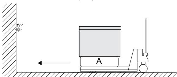
4. Bringen Sie das Gerät auf dem Hubwagen an die vorbereitete Montageposition an der Wand und heben Sie es auf die erforderliche Höhe an.
