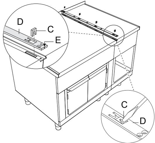
4. Dichten Sie die Verbindung auf ihrer gesamten Länge mit dauerhafterer Silicon-Dichtmasse ab (wir empfehlen graue Fugendichtung, Teilenummer: 059611). Befestigen Sie die Schiene **D** mit den mitgelieferten Schrauben **F**. Setzen Sie den Haken unten an der Blende **G** in die Ösen der Verbindungsschiene ein und schieben Sie Blende **G** nach hinten, bis sie mit der Vorderseite bündig ist.
