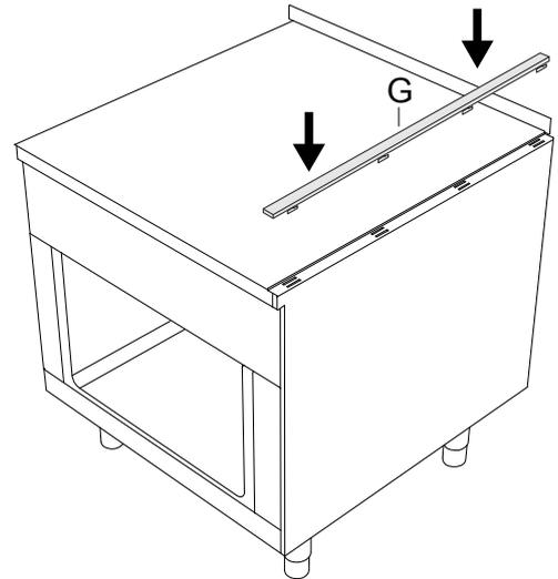
4. Schieben Sie die Abschlusschiene **G** in Pfeilrichtung, bis sie an der Vorderseite bündig anliegt.
