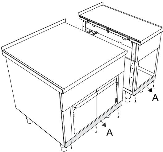
2. Schieben Sie die Geräte aneinander. Bringen Sie die Geräte mit den verstellbaren Füßen auf die gleiche Höhe und richten Sie sie dann waagrecht aus.
