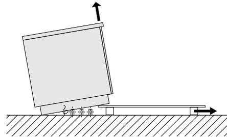
4. Kippen Sie das Gerät, bis es den Boden berührt. Heben Sie dann die Vorderseite an und entfernen Sie die Transportpalette.
