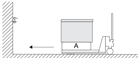
4. Bringen Sie das Gerät auf dem Hubwagen an die vorbereitete Montageposition an der Wand und heben Sie es auf die erforderliche Höhe an.
