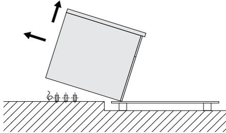
4. Senken Sie das Gerät behutsam ab und schieben Sie es an die korrekte Position. Entfernen Sie schließlich die Transportpalette.
