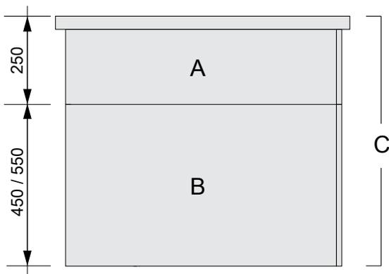
Nella descrizione delle nostre apparecchiature, viene effettuata una distinzione tra i moduli della parte superiore **A**, i moduli della base **B** e le unità assemblate in fabbrica **C**. I moduli della parte superiore e della base possono essere installati insieme oppure come unità individuali.
