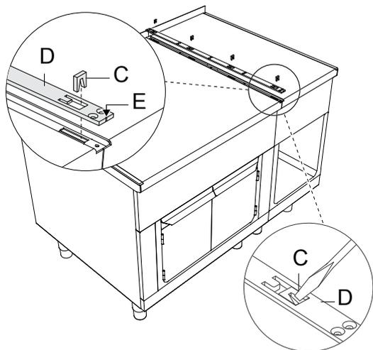
4. Sigillare l'intera fuga con del silicone a lunga tenuta (si consiglia di utilizzare del sigillante per giunzioni grigio, codice: 059611). Fissare la guida **D** utilizzando le viti in dotazione **F**.
