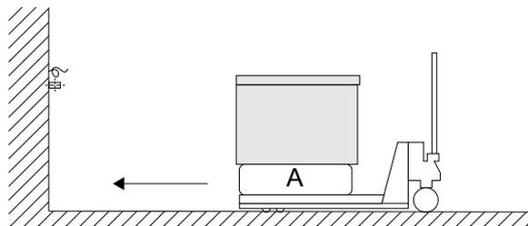
4. Trasportare l'apparecchiatura con il carrello elevatore verso la posizione preparata sulla parete e sollevare l'unità all'altezza corretta.
