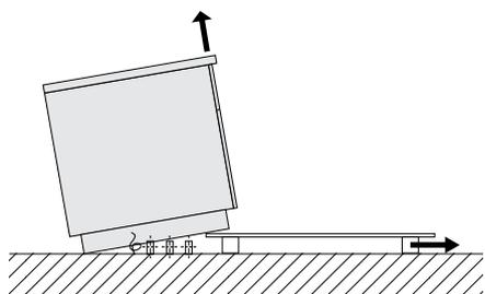
4. Inclinare l'apparecchiatura fino a che non poggia sul pavimento. Sollevare quindi il lato anteriore e rimuovere il pallet di trasporto.
