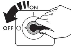
Togliere l'alimentazione all'apparecchiatura prima di procedere a qualsiasi procedura di installazione, montaggio, pulizia o manutenzione.
