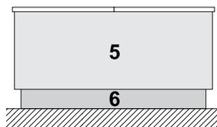
5. Pannelli laterali per il montaggio delle apparecchiature dorso a dorso: altezza 700/800 mm
