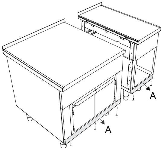
2. Avvicinare le unità. Utilizzare le viti di regolazione sui piedini per portare le apparecchiature alla stessa altezza, quindi livellarle.
