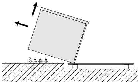
4. Abbassare con cautela l'apparecchiatura e metterla nella posizione corretta. Infine, rimuovere il pallet di trasporto.
