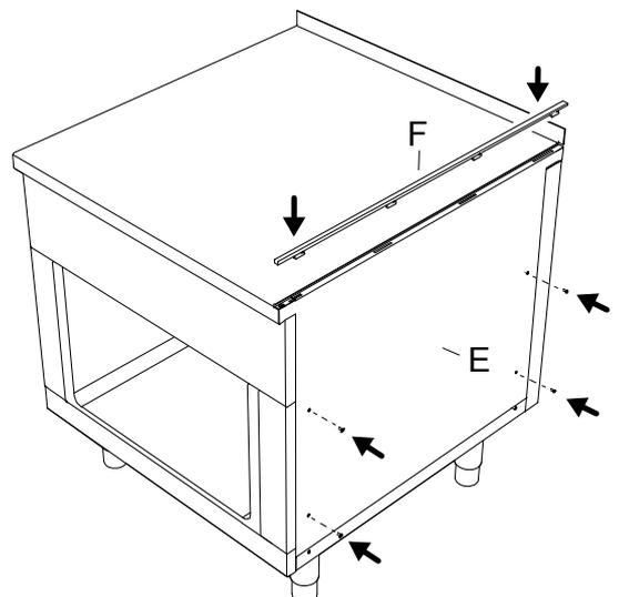
4. Schieben Sie die Abschlusschiene **F** in Pfeilrichtung, bis sie an der Vorderseite bündig anliegt.
