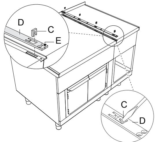
4. Dichten Sie die Verbindung auf ihrer gesamten Länge mit dauerhaltbarer Silikon-Dichtmasse ab (wir empfehlen graue Fugendichtung, Teilnummer: 059611). Befestigen Sie die Schiene **D** mit den mitgelieferten Schrauben **F**. Setzen Sie den Haken unten an der Blende **G** in die Ösen der Verbindungsschiene ein und schieben Sie Blende **G** nach hinten, bis sie mit der Vorderseite bündig ist.
