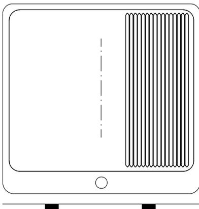
An der Vorderseite der Bratfläche befindet sich eine Ablauföffnung, durch die überschüssiges Fett, Kochsäfte und Reinigungsflüssigkeit in eine Auffangwanne abfließen können.
