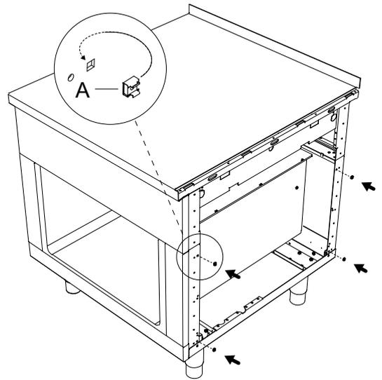
2. Befestigen Sie die Schienen **C** und **D** mit den mitgelieferten Schrauben **B**.
