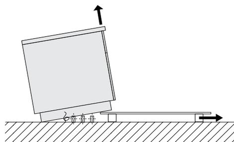
1. Transportieren Sie das Gerät auf der Palette bis direkt zum Aufstellort. Die aus dem Boden herausragenden Installationsanschlüsse müssen sich so nahe wie möglich an der Seite der Transportpalette befinden.
