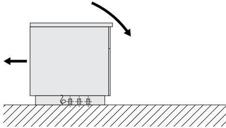
5. Senken Sie das Gerät behutsam ab und schieben Sie es an die korrekte Position.
