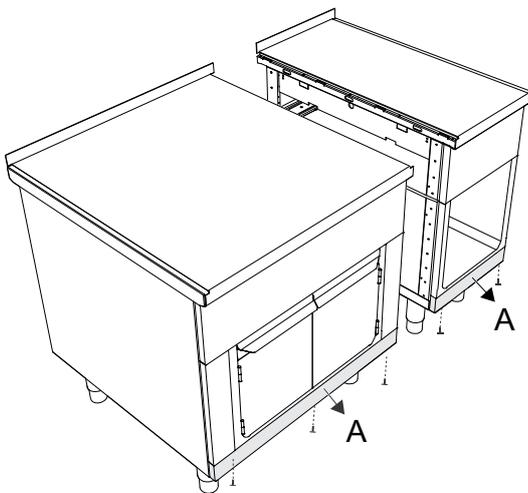
② Schieben Sie die Geräte aneinander. Bringen Sie die Geräte mit den verstellbaren Füßen auf die gleiche Höhe und richten Sie sie dann waagrecht aus.
