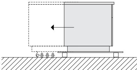
2. 拆下设备底部预先切割好的板。（要进行检修，参见 E.3 安装和连接图）。
