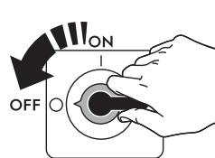
在执行任何安装、组装、清洁或维护程序之前，应把设备断开电源连接。
