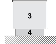
3. 独立式设备的侧板：高度 700/800 mm
