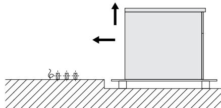
2. 拆下设备底部预先切割好的板。（要进行检修，参见 E.3 安装和连接图）。
