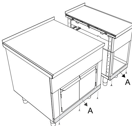
2. 将装置推到一起。使用支脚上的调节螺钉将设备调节至相同高度，然后将它们调平。
