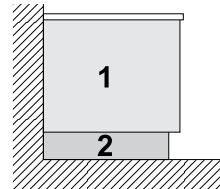
1. 用于墙壁安装的侧板：高度 400/700/800 mm
