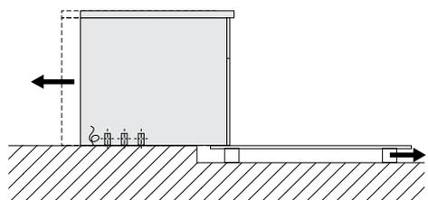
1. Trasportare l'apparecchiatura dal pallet di trasporto direttamente di fronte al punto di installazione.
