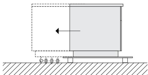
1. Trasportare l'apparecchiatura dal pallet direttamente di fronte al punto di installazione. I collegamenti di installazione che protendono dal pavimento devono essere il più vicino possibile al lato del pallet di trasporto.
