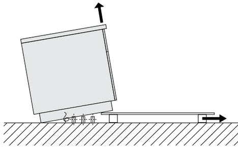
3. Spostare l'apparecchiatura sul pallet di trasporto in modo che tutti i collegamenti di installazione si trovino all'interno dell'apparecchiatura.
