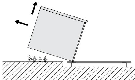
4. Senken Sie das Gerät behutsam ab und schieben Sie es an die korrekte Position. Entfernen Sie schließlich die Transportpalette.
