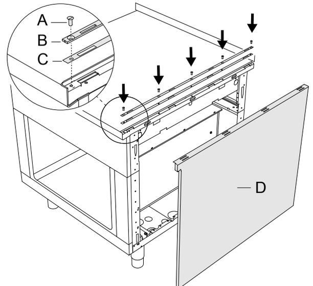
2. Halten Sie die Seitenverkleidung **D** an das Gerät. Setzen Sie die 5 Haken **F** der Verkleidung in die Kerben **E** ein.
