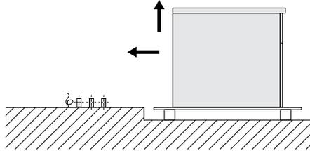
2. Entfernen Sie die vorgestanzte Platte an der Unterseite des Geräts. (Informationen zum Zugang siehe E.3 *Installation und Anschlussdiagramm*.)
