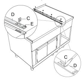
4. Selle toda la longitud de la unión con silicona de larga duración (se recomienda sellado de uniones gris, código: 059611). Fije el carril D con los tornillos suministrados F. Introduzca el gancho de la parte inferior de la cubierta G en los orificios del carril de conexión y deslice la cubierta G hacia atrás hasta alinearla con la parte delantera.
