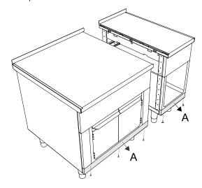
Empuje las unidades para unirlas. Utilice los tornillos de ajuste de las patas para situar los aparatos a la misma altura y nivélelos.
