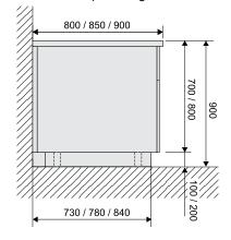
4. En la pared sobre basamento de cemento
