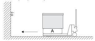
Desplace el aparato en la carretilla elevadora hasta la posición preparada en la pared y elévelo a la altura correcta.
