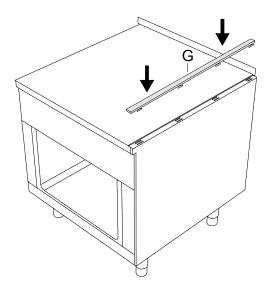
4. Deslice el carril final **G** en el sentido de la flecha para alinearlo en la parte delantera.
