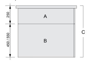
Al describir nuestros aparatos distinguimos entre módulos superiores**A**, módulos de base **B** y unidades montadas en fábrica **C**. Los módulos superiores y de base se pueden configurar juntos o como unidades aisladas.
