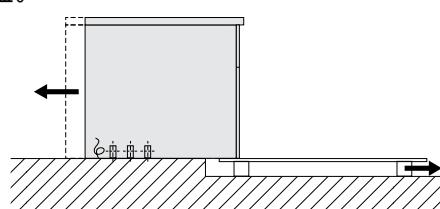
5. 拆下外部保护膜和边缘护盖，注意不要刮擦设备的表面。十分小心地拉下不锈钢表面上的保护膜，不要撕裂，防止留下任何粘合剂残余物。
