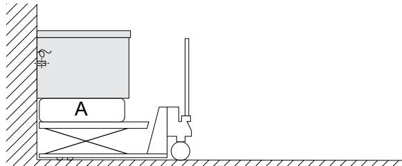
5. 拆下外部保护膜和边缘护盖，注意不要刮擦设备的表面。
