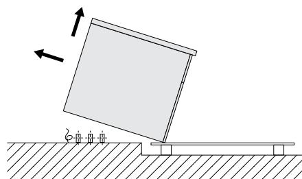
4. 小心地放下设备，然后将其移动到正确位置。最后，拆下运输托盘。
