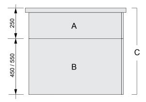
Pour la description des appareils, il faut faire la distinction entre modules hauts **A**, modules de base **B** et unités montées en usine **C**. Les modules hauts et de base peuvent être installés ensemble ou séparément.
