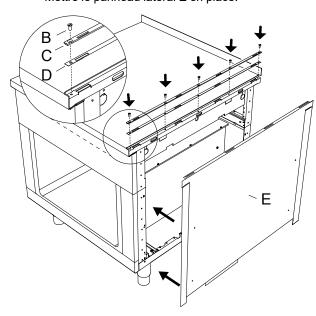
Introduire les crochets du bas de la glissière d'extrémité F dans les œillets de la glissière de raccordement. Accrocher le côté du couvercle latéral E à l'aide des 4 vis à tête plate fournies. Faire glisser la glissière d'extrémité **F** dans le sens de la flèche pour l'aligner sur l'avant.
